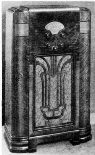
Typisch amerikanischer Schrankapparat einer der führenden amerikanischen Firmen. Arbeitet mit 9 Metallröhren. Unter der eigentlichen Einstellskala das kleine Fenster für den Schattenanzeiger zur optischen Kontrolle der Einstellschärfe. Der Knopf in der Mitte unten dient der Kontrolle der Bandbreite; Drehung nach rechts bringt bessere Tonwiedergabe, Drehung nach links schärfere Abstimmung. Werkphoto.
